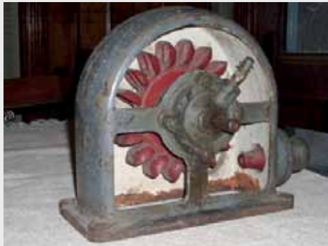
Waertmotor eind 19e eeuw met een kant van de behuizing verwijderd. (www.oldpelton.net)
