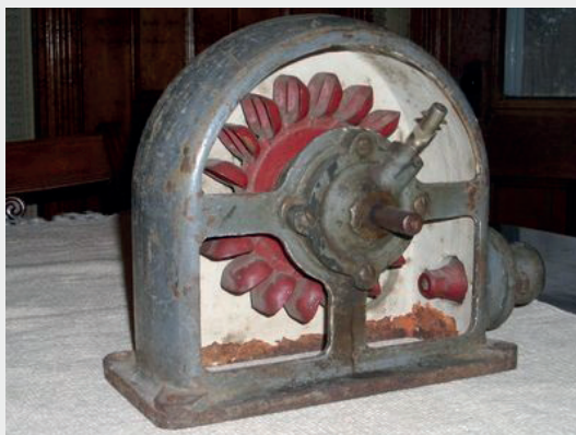
Motor d'água do final do século XIX com um lado da caixa removido. (www.oldpelton.net)
